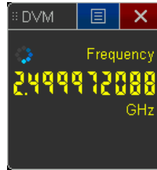
Рисунок 32. 10-разрядный частотомер, выполняющий точное измерение частоты сигнала 2,5 ГГц.
