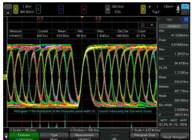
Рисунок 16б. Гистограмма результатов измерения ширины импульса.
