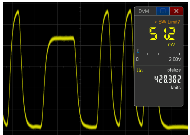
Рисунок 35. Суммирование количества вырожденных импульсов.
