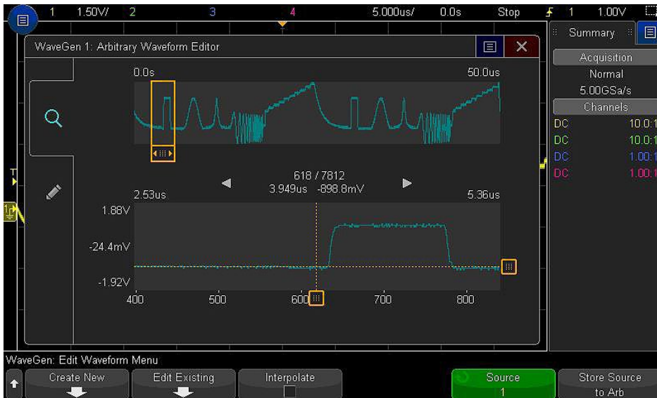
Рисунок 25: Опциональный генератор сигналов произвольной формы обеспечивает простое формирование входных сигналов. Встроенный генератор сигналов произвольной формы позволяет очень просто захватывать, изменять и воспроизводить сигналы.
