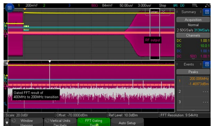
Рисунок 21d: РЧ-сигнал стабилизируется на частоте 200 МГц, что показывается в списке.
